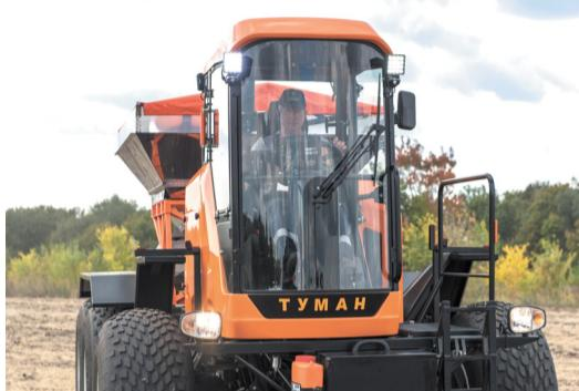
опрыскиватель вентиляторного типа. Оснащен новейшим навигационным оборудованием, которое позволяет работать в системе точного земледелия. Комплектуется колесами низкого давления и узкими колесами, не повреждая растения и не уплотняет почву. Кабина оборудована кондиционером с системой фильтрации воздуха и обогревом. Окупается за 1,5-2 сезона.
